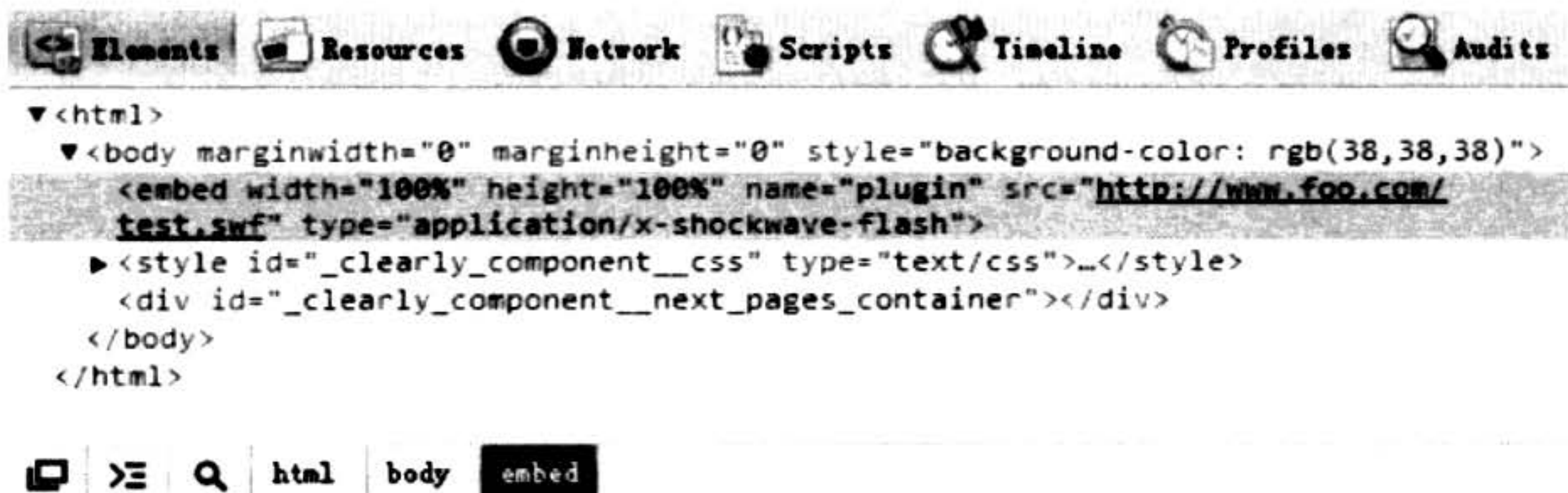
图 2-8 针对直接加载 swf 文件，默认的 HTML 代码
