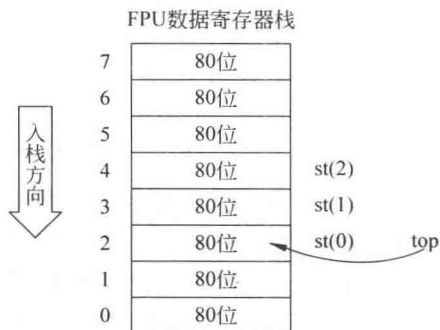
图 1.35 x87 浮点芯片的数据寄存器栈
