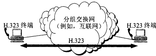
图 8-13 H.323 终端使用 H.323 协议进行多媒体通信
