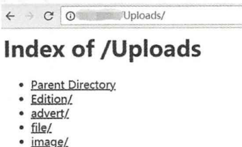
图7-36 目录浏览漏洞
