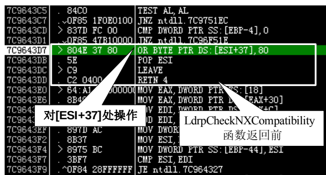
图 12.3.16 LdrpCheckNXCompatibility 函数返回前对[ESI+37]进行操作
