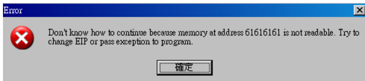
图 18.4.3 Easy FTP Server v1.7.0.2 程序发生了溢出错误
