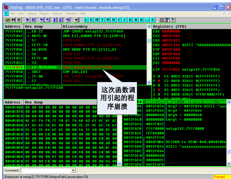
图 26.2.4 在漏洞被触发前设置断点
