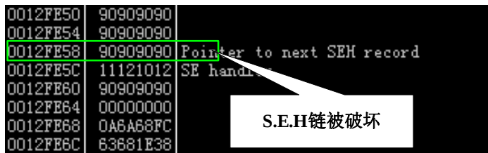
图 14.5.3 S.E.H 链被破坏
