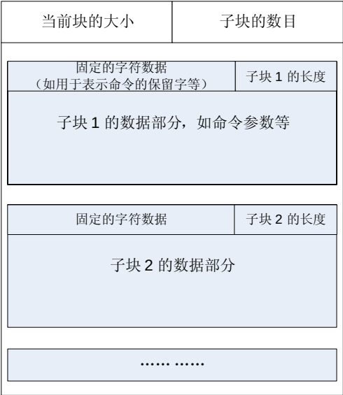
图 16.2.1 基于 Block 的数据定义方法
