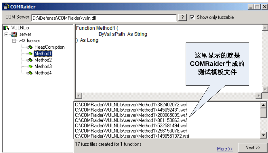
图 20.3.6 选择“Fuzz member”选项后程序将自动生成测试模板文件
