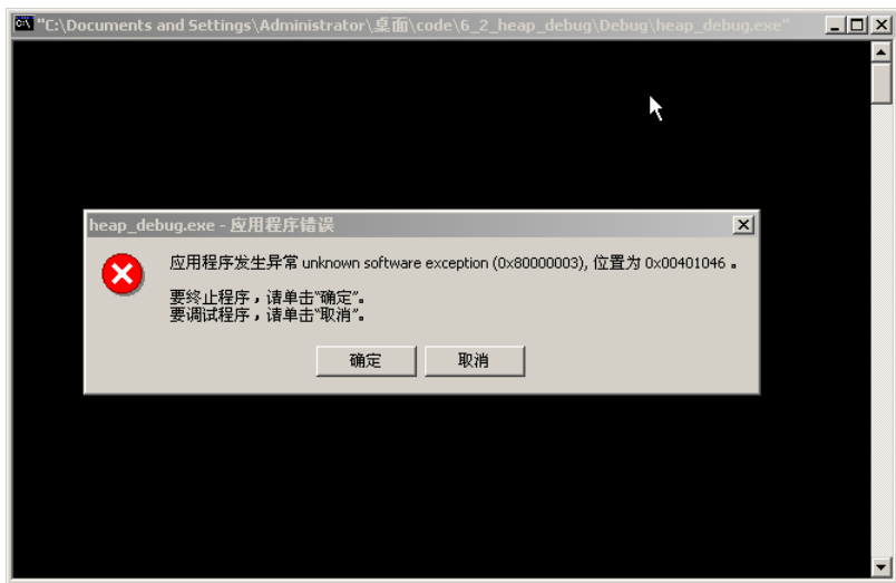
图 5.2.3 通过人工断点中断程序
