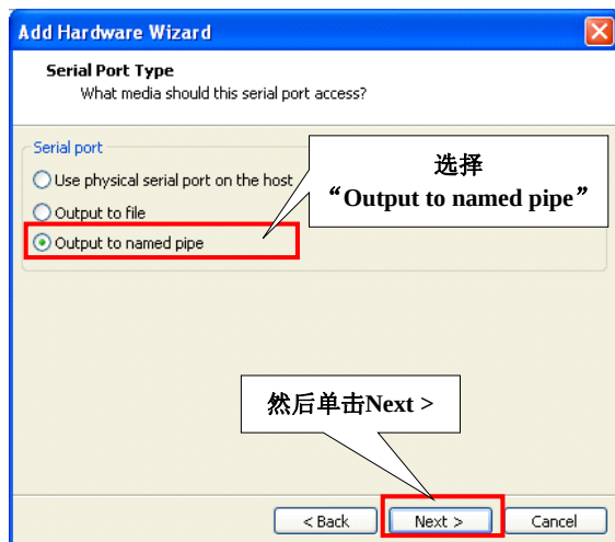
图 21.2.4 设置串口为输出到命名管道
