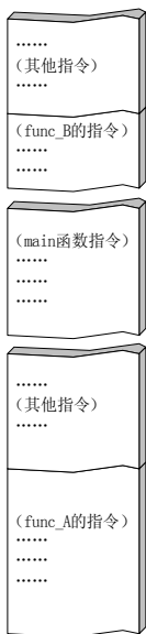
图 2.1.2 函数代码在代码区中的分布示意图
