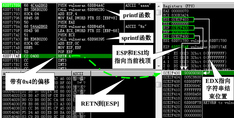
图 13.2.4 V ulnerAX.ocx 中 test 函数返回前内存状态
