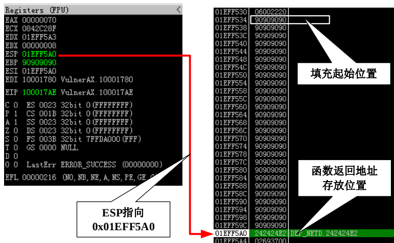
图 12.5.6 ActiveX 控件溢出后的内存状态
