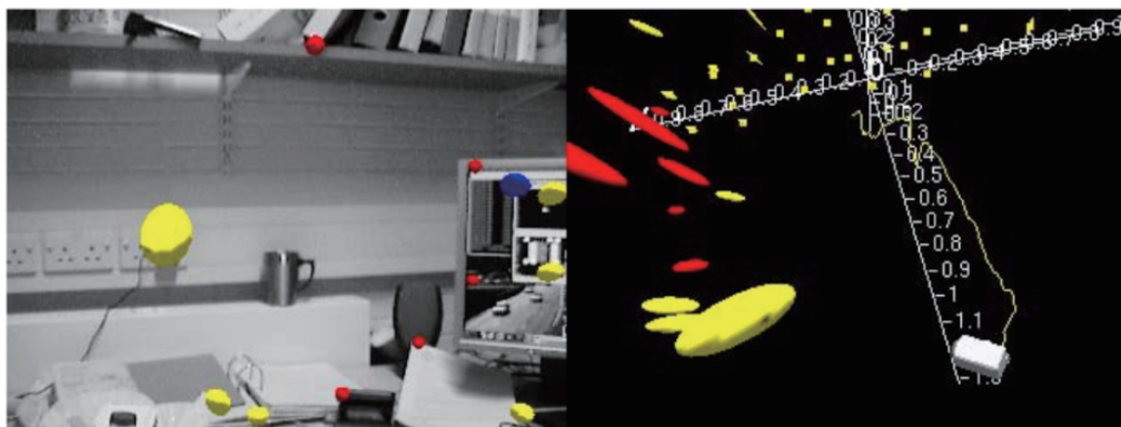
图 14-1 MonoSLAM 的运行截图。左侧: 追踪特征点在图像中的表示; 右侧: 特征点在三维空间中的表示。
