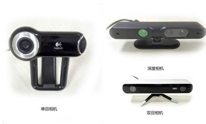
图 2-3 形形色色的相机: 单目, 双目和深度相机。
