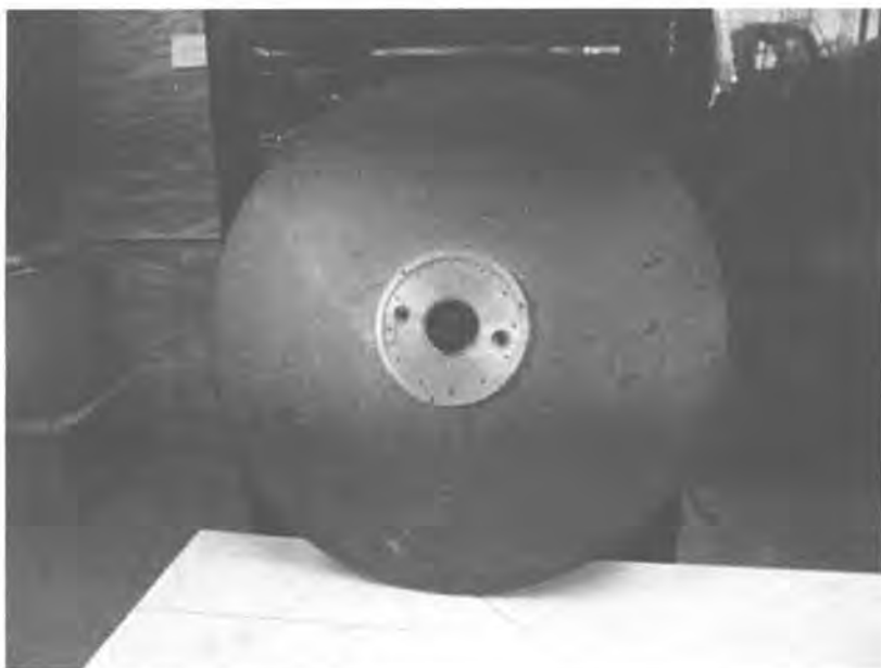
图 A.3: 硬盘的盘片, 3/8 英寸厚, 直径 36 英寸
