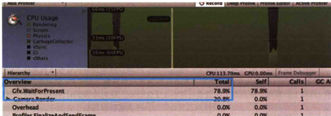
图 15-24 当设备不支持 GPU 分析时通过 CPU 分析器判断是否是 GPU 受限
