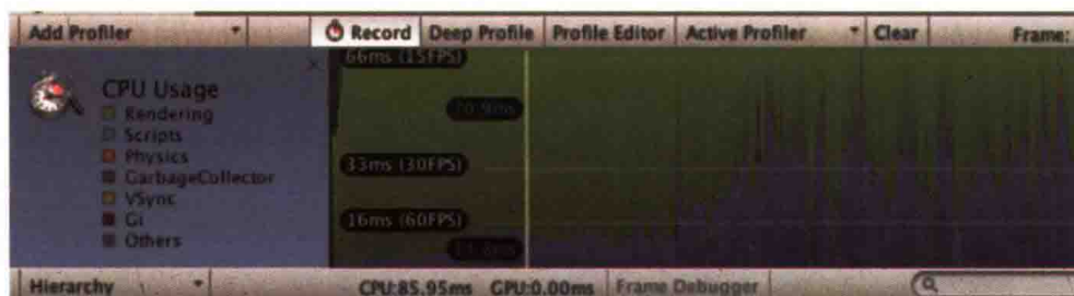
图 15-19 CPU 分析器窗口显示了总执行时间
