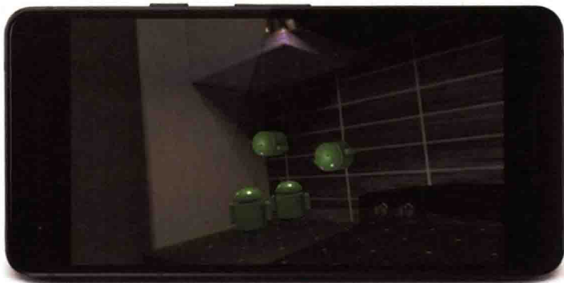
图 4-16 连接到锚点上的虚拟对象如同固定在现实世界空间中一样
