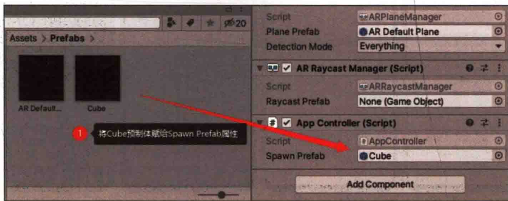
图 1-25 为 AppController 脚本组件 Spawn Prefab 属性赋值
