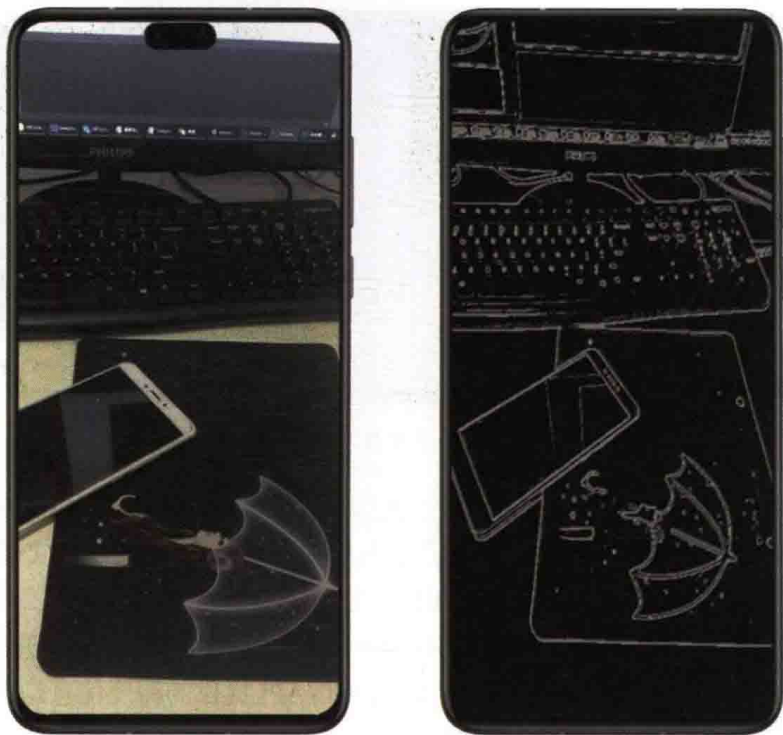
图 9-12 Sobel 算子对 CPU 获取的摄像头图像进行边缘检测效果
