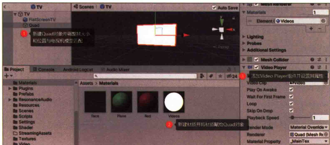
图 11-18 实现三维视频播放的步骤
