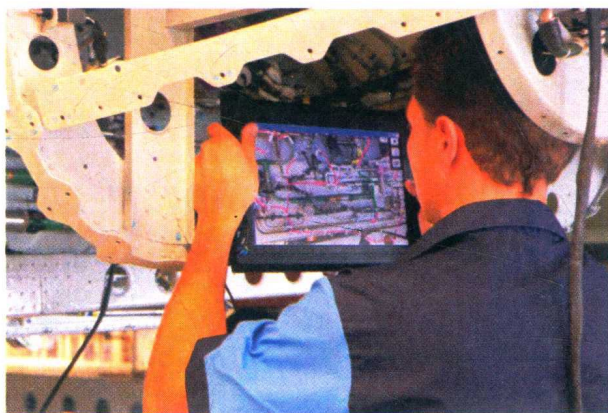
图 1.14 使用欧洲空客集团开发的“月亮”AR 系统指导 A400M 运输机电缆安装(Serván et al., 2012)
