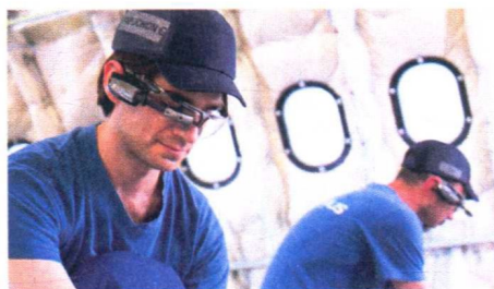
(b) 空客集团工人佩戴 AR 眼镜安装 A330 客舱座椅 ②
